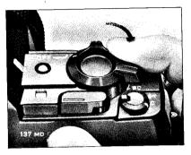
Die Batterien durch Drehen de Hauptschalters in Richtung "B-C" (Batterieprüfung) überprüfen. Leuchtet die Hauptlampe grün auf, ist die Batteriespannung normal. Bei Spannungsabfall wird die Lampe allmählich dunkler ur die Filmumspulung langsamer. Ist dies der Fall, neue Batterien einsetzen. Die grüne Lampe leuchtet nicht auf, wenn Nickel-Kadmiumbatterien verwende
